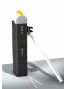
G028011 Attacco porta asta sganciabile. Dopo l'impatto, l'estremità dell'asta sganciata si appoggia a terra. Lunghezza max. asta = 6 m.
