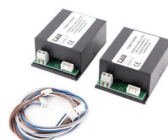
900T-COMM Interfaccia per il collegamento di 2 quadri di comando in modalità master/slave per T-ONE8BR e T-ONE10B
