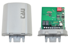
900TWM Sistema master wireless da esterno per max. 8 bordi sensibili
