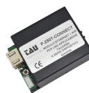
250T-CONNECT Dispositivo ethernet + Wi-Fi per consentire da remoto, mediante l'applicazione TauOpen, l'uso dello smartphone per aprire/chiedere e controllare lo stato del cancello
