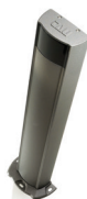
900TOWERF Colonnina in alluminio verniciato per fotocellule a 1 foro h 49 cm (frontale estraibile per passaggio cavi e montaggio fotocellula orientabile in 3 posizioni)
